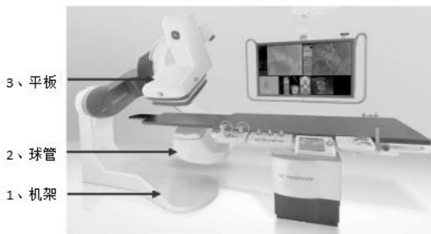
图 9.2-2 某型数字减影血管造影机（DSA）设备外观图
